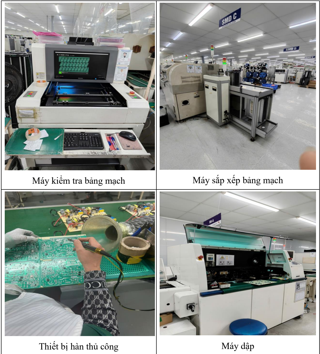
Hình 1.5. Hình ảnh một số máy móc phục vụ gia công mạch điện tử của cơ sở
