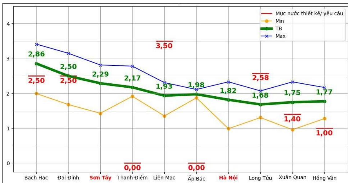
Hình 21. Dự báo mực nước tại một số công trình thủy lợi trong đợt xả số 02 (TH2)
